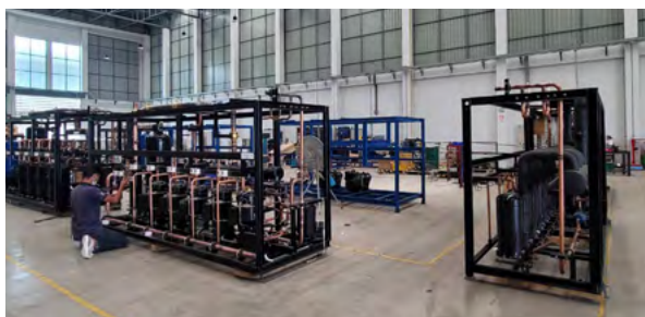
Refrigeration System Manufacturing Plant โรงงานผลิตและทดสอบระบบทำความเย็น
